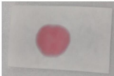
Um dos papéis contendo a mancha do extrato será a referência para a análise (A) e o outro será exposto às transformações químicas (B). A comparação entre a mancha de referência e aquela utilizada nas reações, possibilitará a validação da técnica.
