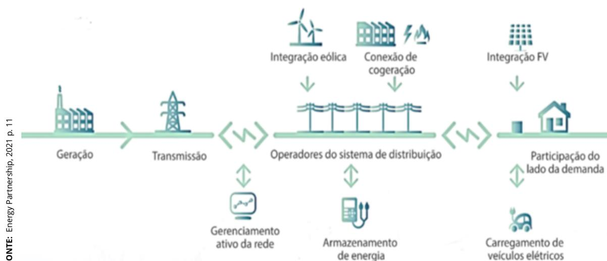
**Figura 3.7** – O sistema de geração, transmissão e distribuição de energia elétrica de forma bidirecional
