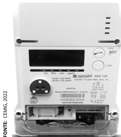
Figura 3.10 – Medidor Inteligente
