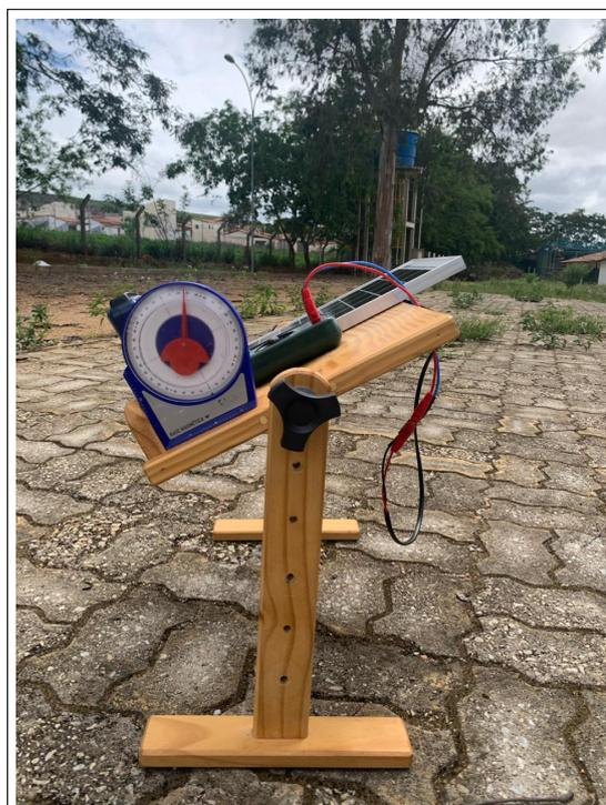
**Figura 3.8** – Medição da irradiância solar e corrente de curto circuito no plano inclinado (ângulo igual a  $28^\circ$ ) e direção Norte.
