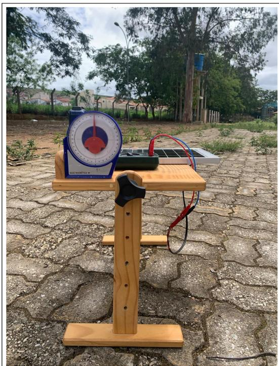
**Figura 3.5** – Medição da irradiância solar e corrente de curto circuito no plano horizontal (ângulo igual a  $0^\circ$ ) e direção Norte.
