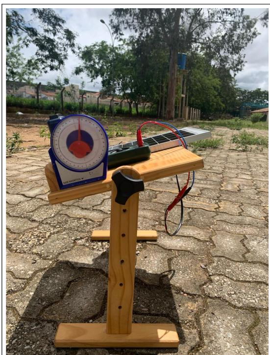
**Figura 3.7** – Medição da irradiância solar e corrente de curto circuito no plano inclinado (ângulo igual a  $15^\circ$ ) e direção Norte.
