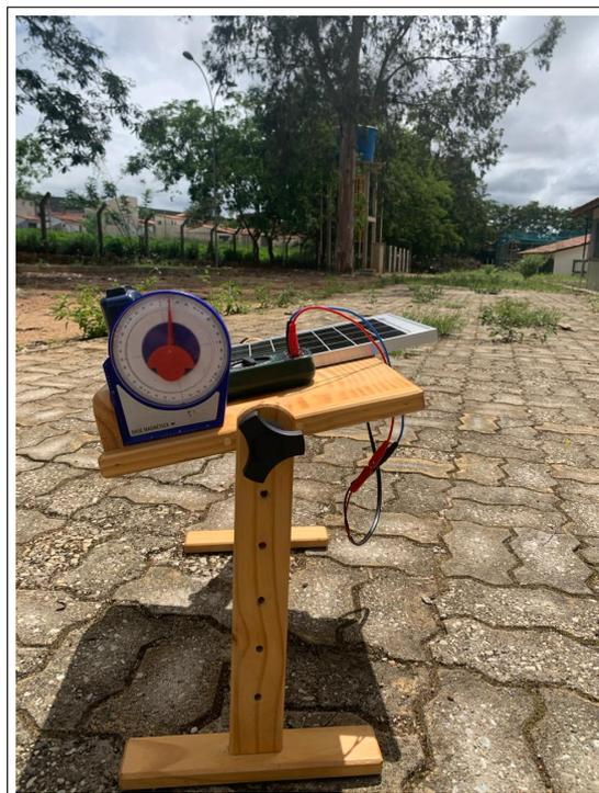
**Figura 3.6** – Medição da irradiância solar e corrente de curto circuito no plano inclinado (ângulo igual a  $12^\circ$ ) e direção Norte.
