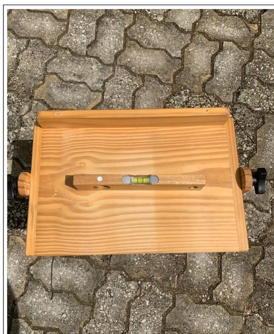
**Figura 3.2** – Verificação do nivelamento do suporte em relação à superfície horizontal com um nível de madeira.
