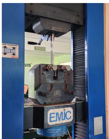
Figura 11: a) Máquina de Tração EMIC; b) Máquina de Tração Tinius Olsen.
