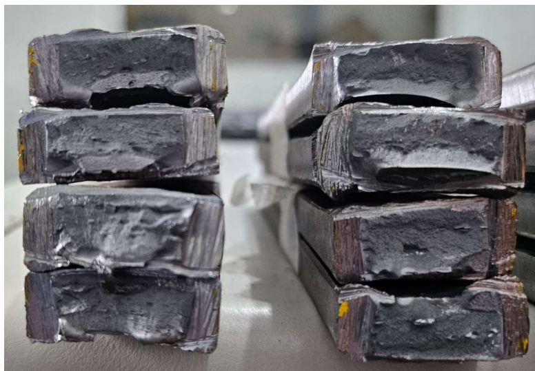
Figura 26: Fraturas dos Corpos de Prova Após Ensaio de Nick Break.
