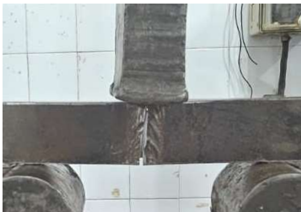
Figura 17: Amostra de Corpo de Prova de Nick Break no Equipamento de Ensaio.
