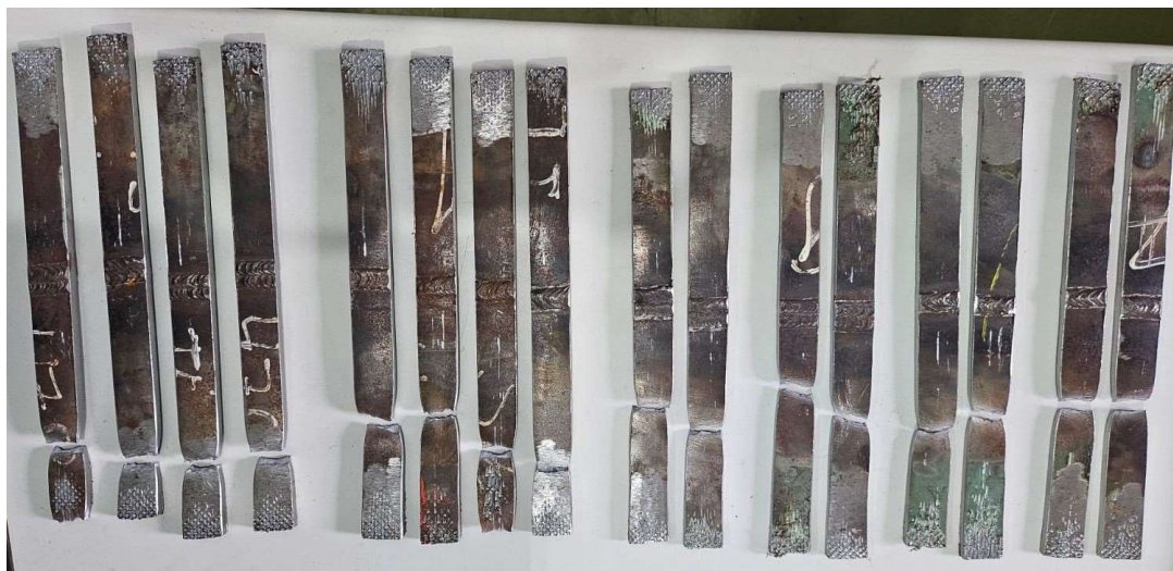
Figura 24: Corpos de Prova de Tração com Ruptura Fora da Solda.
