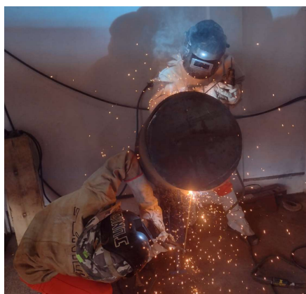
Figura 4: Soldagem realizada em Minas Gerais nos corpos de prova ELEV-010 e ELEV-014.
