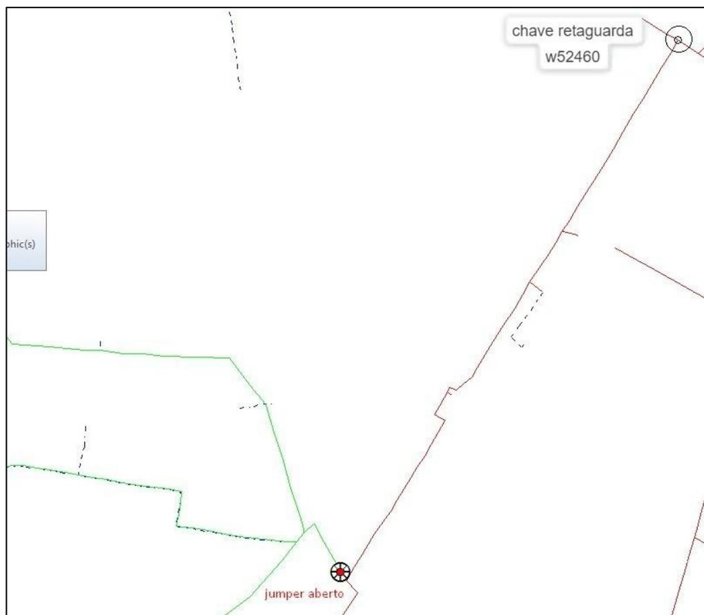
**Figura 6.11.** Circuito analisado no evento identificando o jumper aberto pela equipe. Fonte: GSE (2023).
