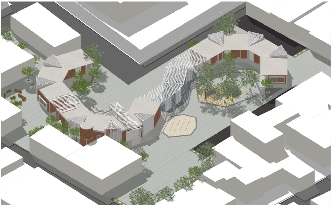
O projeto conta com um pergolado que conecta a Ciranda 1 e Ciranda 2 e outro pergolado que conecta a Ciranda 2 e 3. Ambos são de perfil metálico. O projeto atende ainda aos ambientes propostos no fluxograma e no esquema «definição de uns espaços» mostrados anteriormente.
