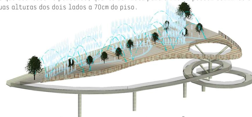
Precisou ser implementada uma estrutura de concreto<sup>7</sup> para a sustentação da rampa e do vazio circular [criado para possibilitar uma amplitude da vista do percurso da rampa, e do rio].
