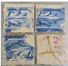
**Figura 120** – Remoção do reboco remanescente do substrato das paredes de suporte.
