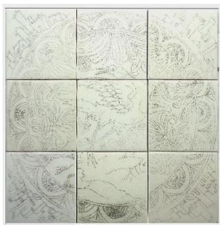
**Figura 11** – Peças com o design pintado, antes de ir para o forno.
