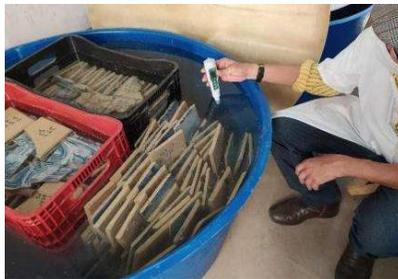
**Figura 115** – Azulejos no reservatório para a dessalinização, tendo a salinidade medida.
